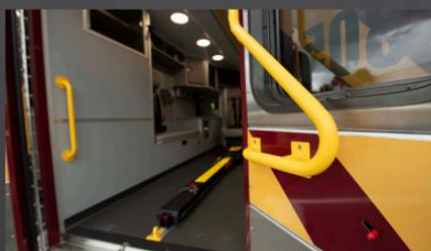
BARANDILLAS DE SEGURIDAD AMARILLAS EN MÓDULO PARA FACILITAR LA VISIBILIDAD
