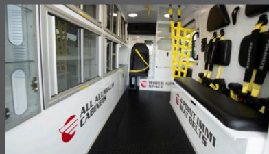
CONSTRUCCIÓN DE GABINETES DE ALUMINIO
